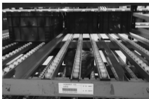
图 2 低位超市货架的滚轮设计
